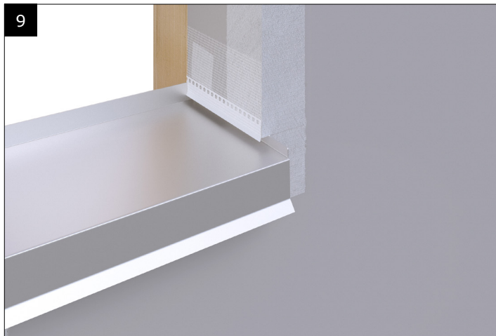
9 Tilpas Alfix Uni-liste til underkant af falsbeklædning. NB! - Det anbefales at beskytte sålbænk mod mørtelspild. (Murer)
